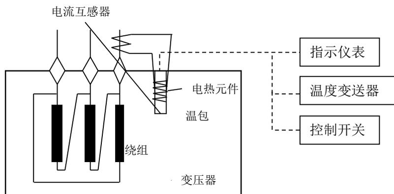
图 1 绕组温控器结构示意图
