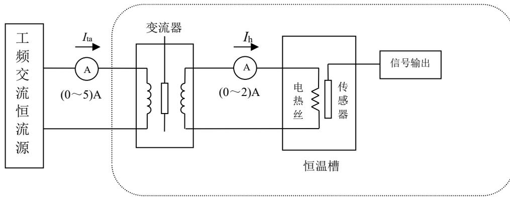
图2 温升误差试验电路图
